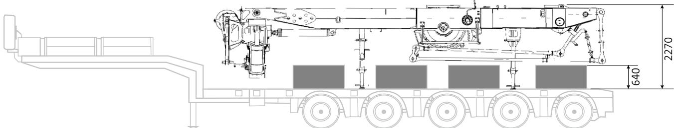
Configuration with 4 x 10 t counterweight slabs, 10 t MegaWingLift • Konfiguration mit 4x10 t Gegengewichtsplatten und 10 t MegaWingLift • Configuration avec 4 plaques de contrepoids de 10 t et MegaWingLift de 10 t • - Configuración con 4 placas de contrapeso de 10 t y MegaWingLift de 10 t • Configurazione con 4 bramme di contrappeso di 10 t, MegaWingLift di 10 t • Конфигурация с блоками-противовесами – 4 шт. x 10 т, MegaWingLift 10 т.
